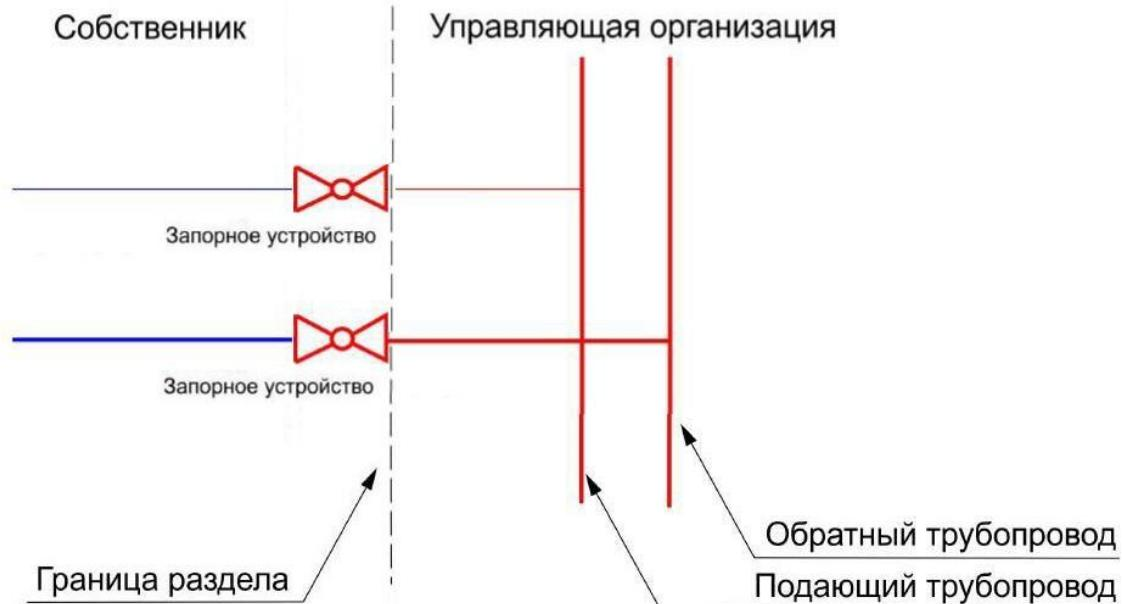
Граница ответственности за состояние и содержание системы отопления проходит до первого резьбового соединения запорного устройства на стояке отопления.
